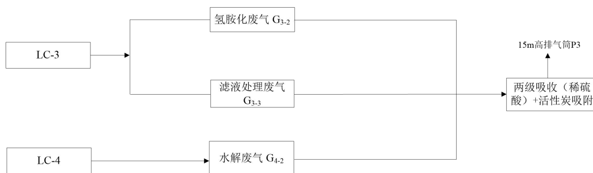
图 5.2-3 含氨废气治理示意图
